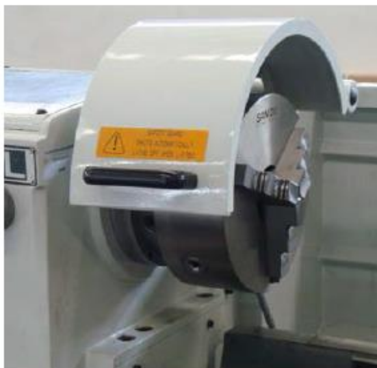
Защитный кожух патрона токарного станка
